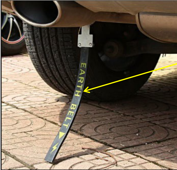
Resim 2: Araç topraklama lastiği (şok lastiği)
