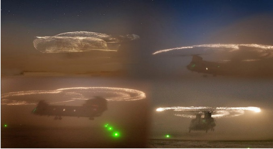
Resim 4: Helikopterde meydana gelen statik elektriklenme
